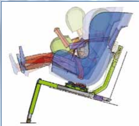
Simulazione di una prova ECE-R44 su un seggiolino classe 1.
